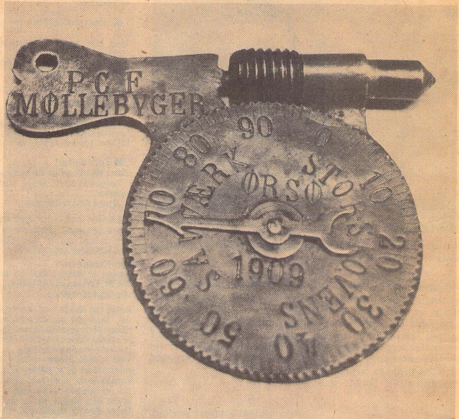
Omdrejningsmåleren fra 1909, som møllebygger P.C. Frederiksen opfandt og lavede til sin maskine på Storskovens Savværk, Ørsø. Materialet er messing.
